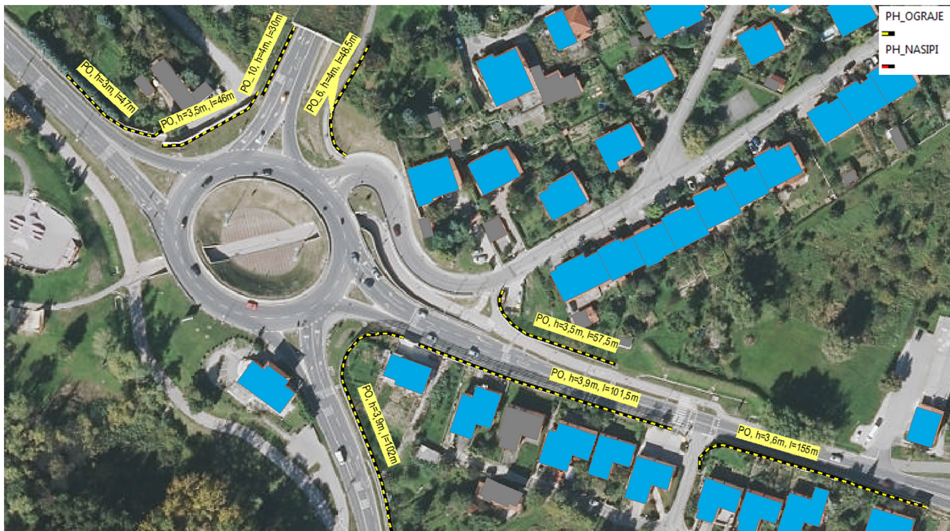
Slika 26: Protihrupne ograje na območju krožišča na začetku Solkanske obvoznice (križišče Vojkove in Kromberške ceste)
