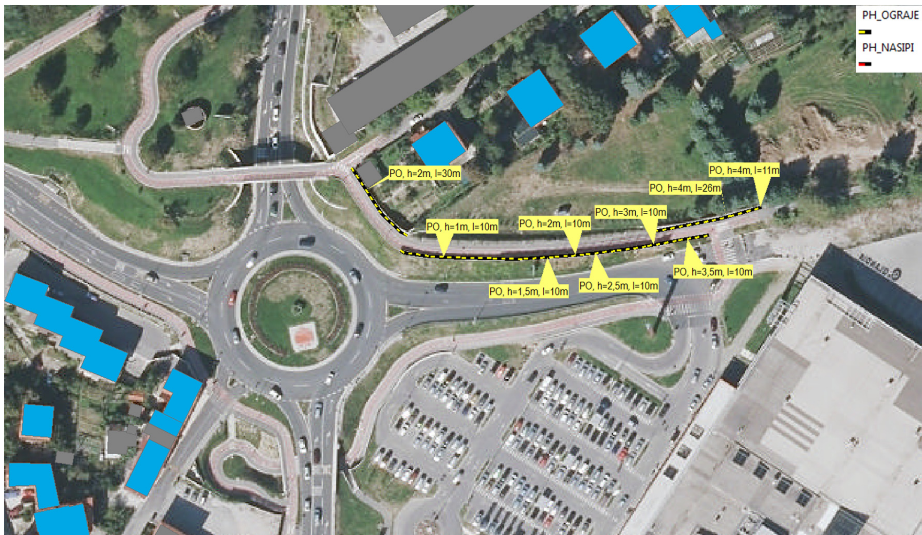
Slika 30: Protihrupne ograje ob Vodovodni ulici pri novem krožišču pri Q-landiji
