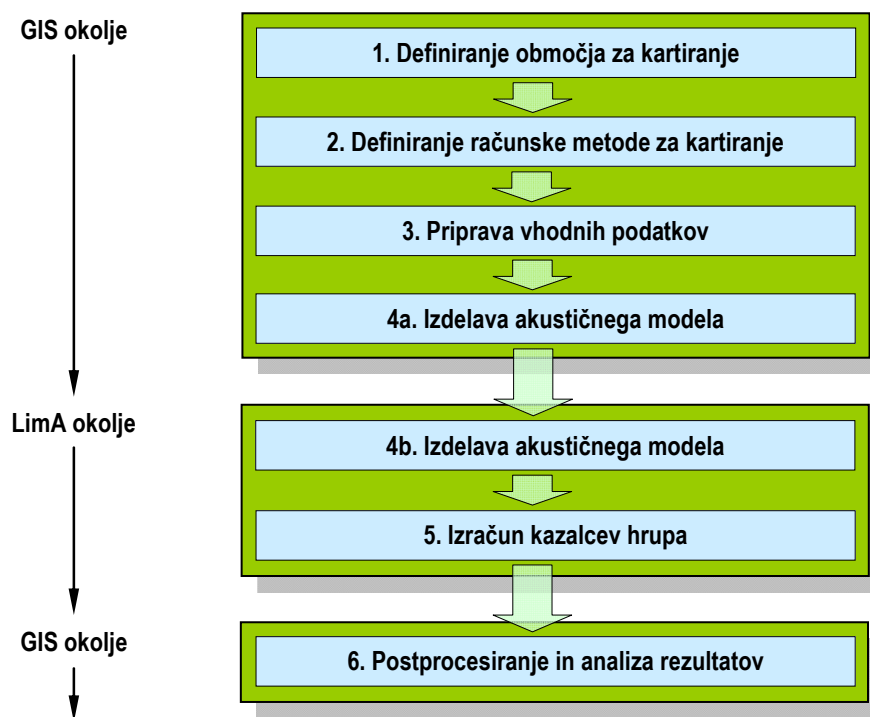
Slika 21: Shematski prikaz pristopa k izdelavi strateške karte hrupa
