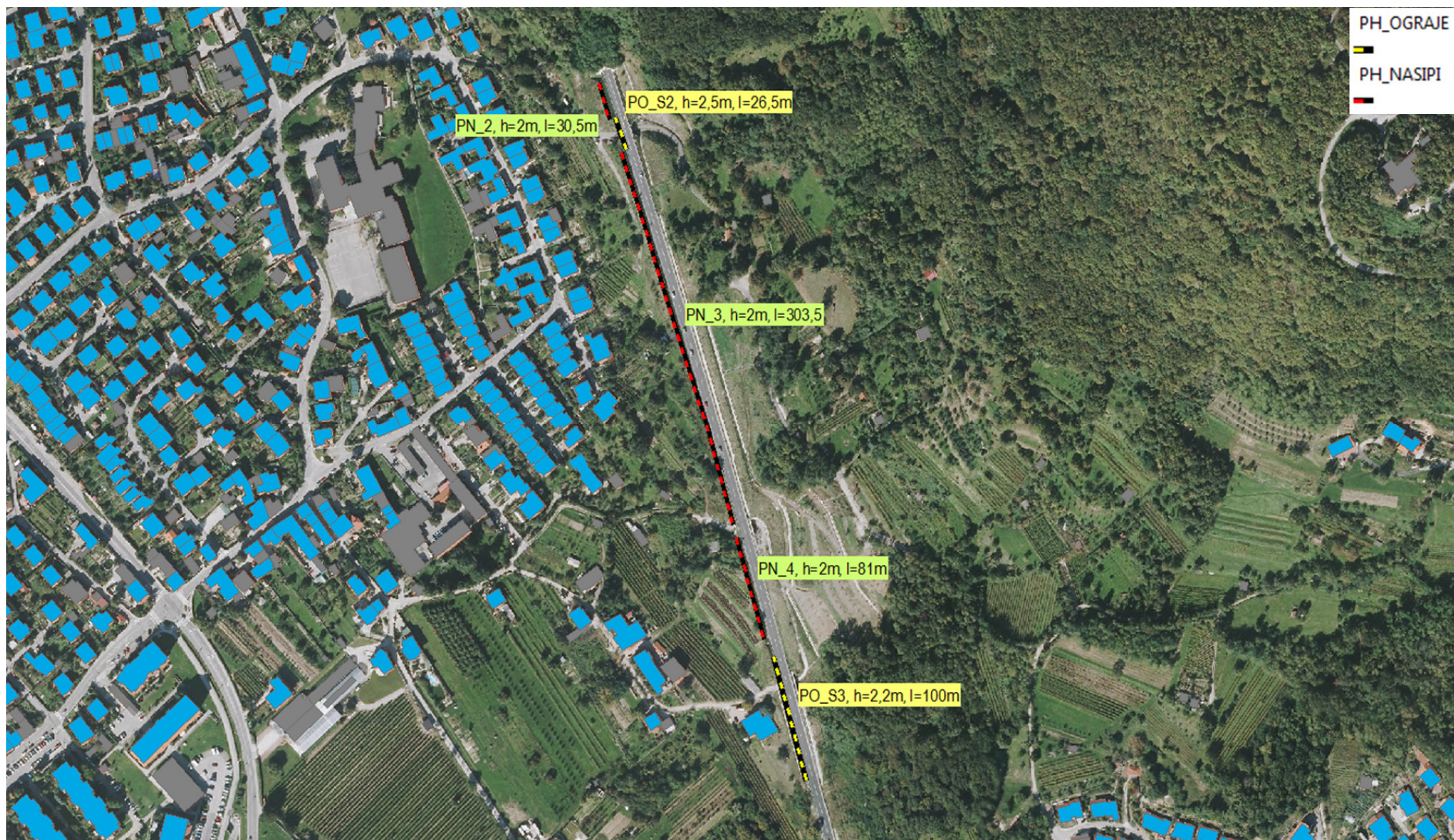
Slika 28: Protihrupne ograje in nasipi vzdolž Solkanske obvoznice J od tunela
